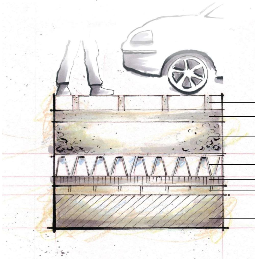
— Lastre sp. min. 60 mm o piastre min. 40 mm / 100 mm
