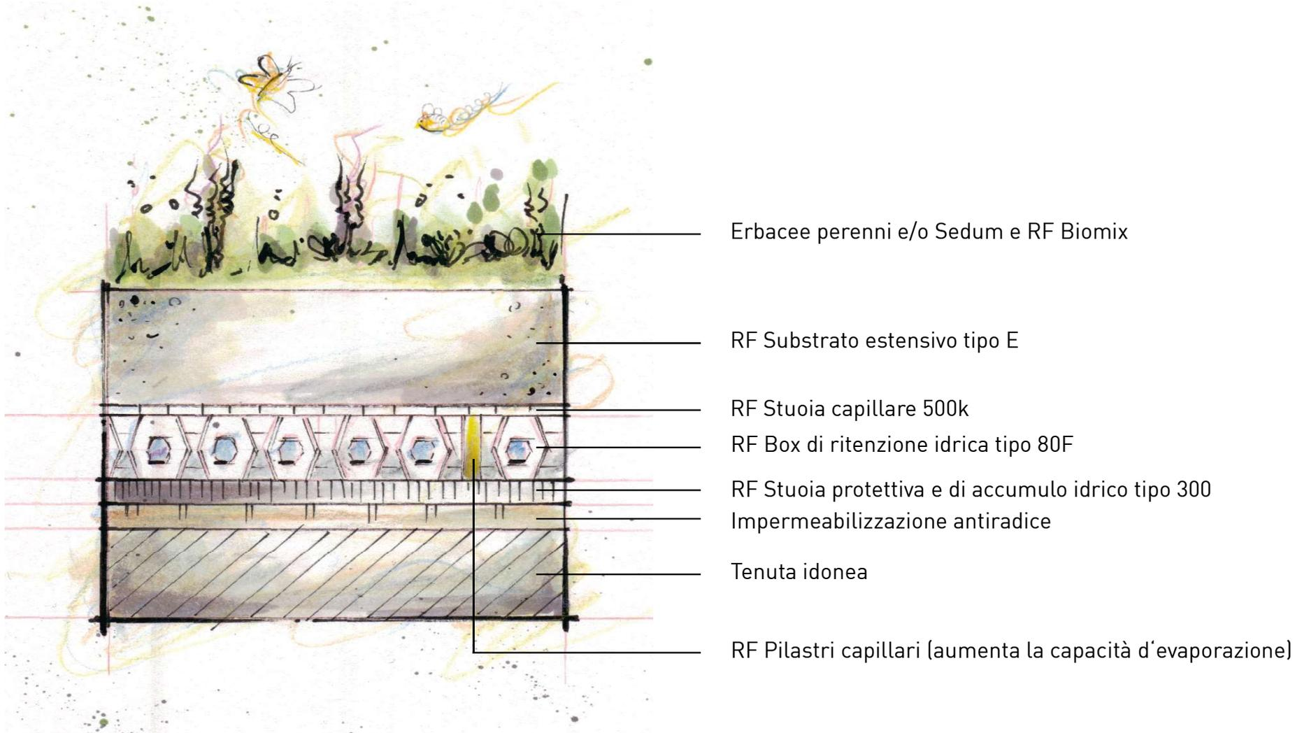
Il presente disegno non è in scala e si riferisce alla struttura di inverdimento. La tenuta è rappresentata in modo semplificato e deve essere progettata e realizzata a regola d'arte secondo le necessità di progetto.
