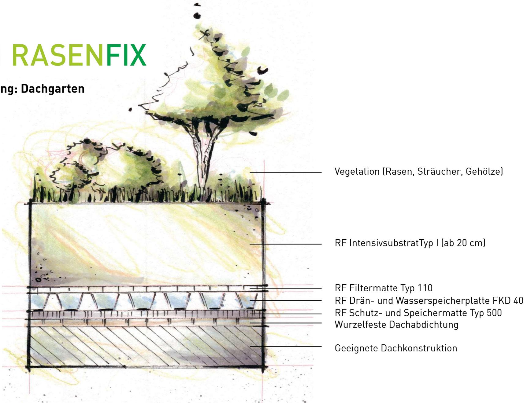
Die dargestellte Detaillösung ist nicht maßstabgetreu und bezieht sich auf den reinen Begrünungsaufbau. Die Dachkonstruktion selbst ist schematisiert dargestellt und muss entsprechend der Fachregel für Dächer mit Abdichtungen geplant und ausgeführt werden.
