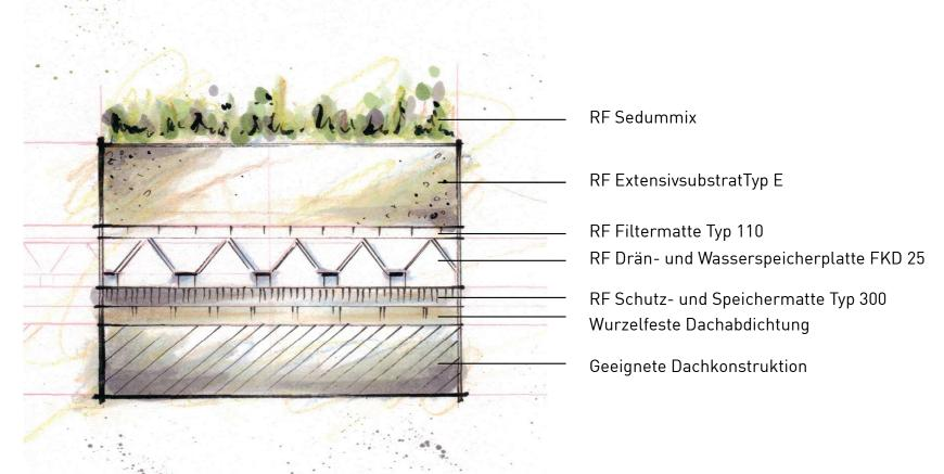
Die dargestellte Detaillösung ist nicht maßstabgetreu und bezieht sich auf den reinen Begrünungsaufbau. Die Dachkonstruktion selbst ist schematisiert dargestellt und muss entsprechend der Fachregel für Dächer mit Abdichtungen geplant und ausgeführt werden.
